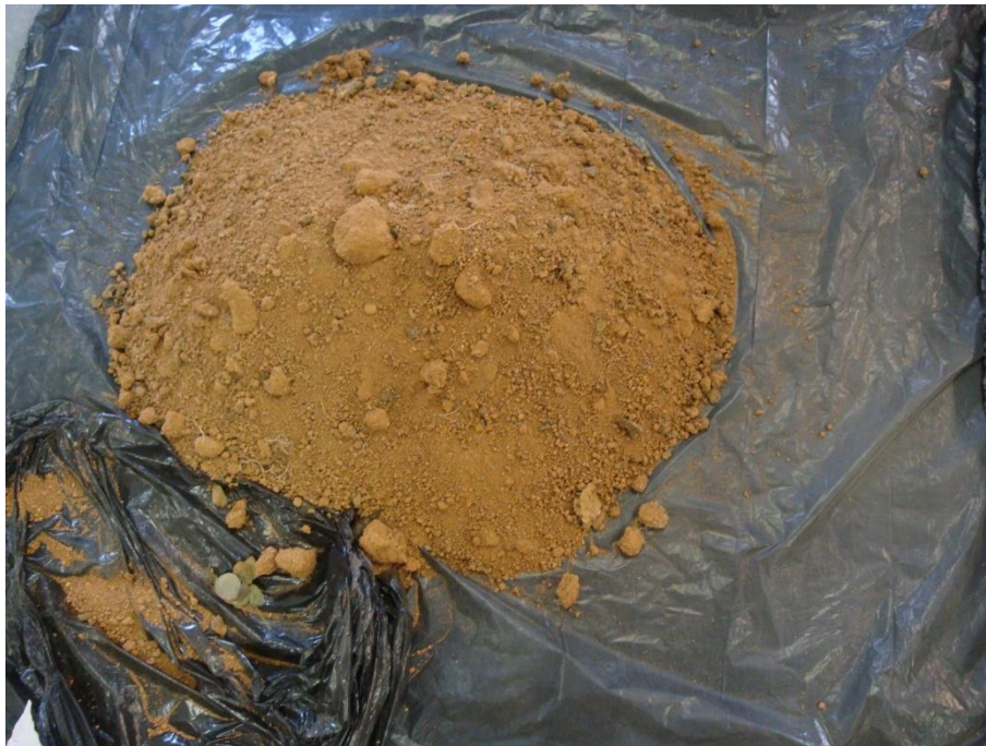
Figura 4 - Destorroamento e Homogeneização do solo.
