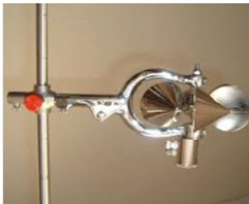
**FIGURA 3.2** Molinete hidrométrico
