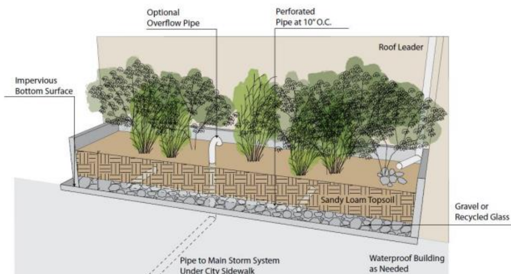
Figura 15 — Componentes de um sistema de biorretenção.
