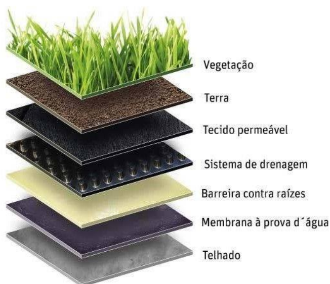
Figura 4 — Estrutura do telhado verde.
