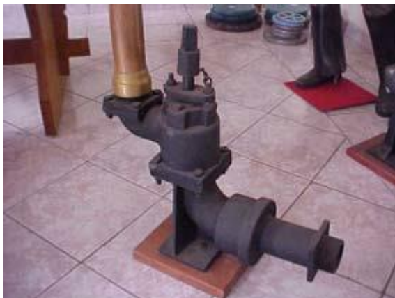
Figura 3 – Exemplo de hidrante subterrâneo
