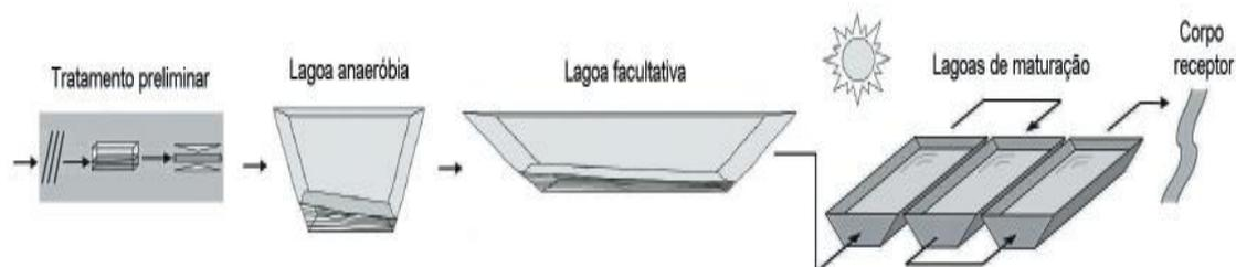
Figura 10: Fluxograma de um sistema simplificado composto de reator Lagoas Facultativas + Lagoa de Maturação (Fonte: ReCESA 2, 2008).
