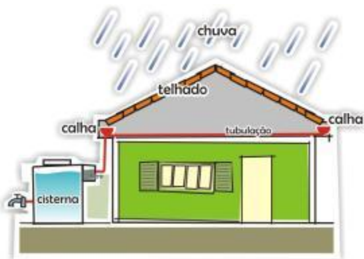
Figura 10 - Esquema simplificado de um sistema de aproveitamento de chuva
