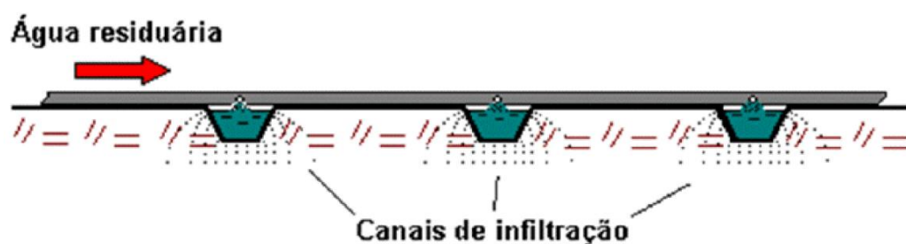
Figura 5 - Representação esquemática de um sistema de infiltração - percolação
