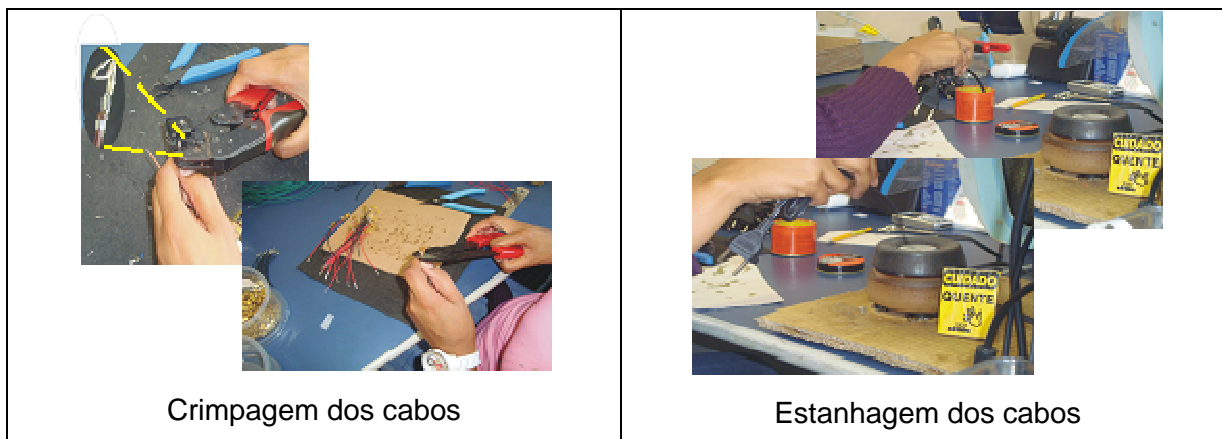
Figura 3.5 – produção de cabos do chassi
