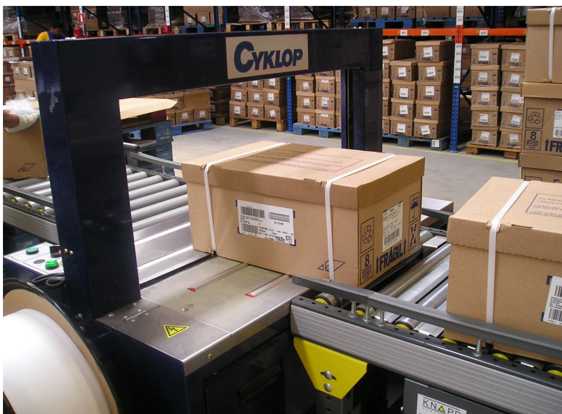
FIGURA 31: FECHAMENTO DA CAIXA (CINTADEIRA) FONTE: O AUTOR
