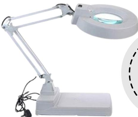
**É aconselhado que no local onde é realizada a inspeção, além de uma iluminação satisfatória, tenha como auxílio lentes intensificadoras de imagem com, no mínimo, oito vezes de aumento, que proporcionam uma completa visão do material preparado.**
