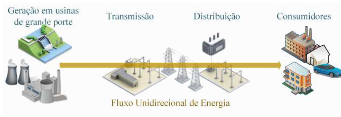
Figura 6: Rede Elétrica Tradicional
