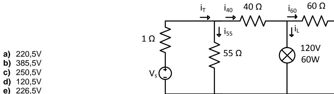
56. No circuito de corrente contínua da figura a seguir, a tensão, em V, entre os pontos A e B é de:
