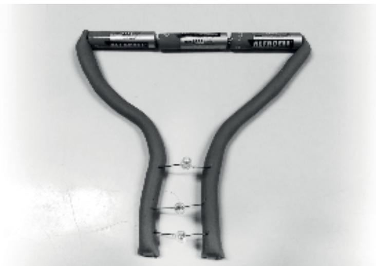
Figura 4: Circuito com as baterias em série e os LEDs em paralelo.
