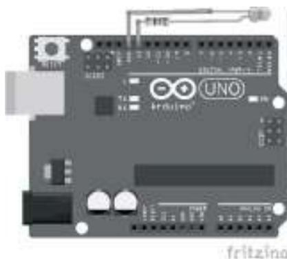
Figura 9: Esquema de montagem para piscar um LED<sup>16</sup>.
