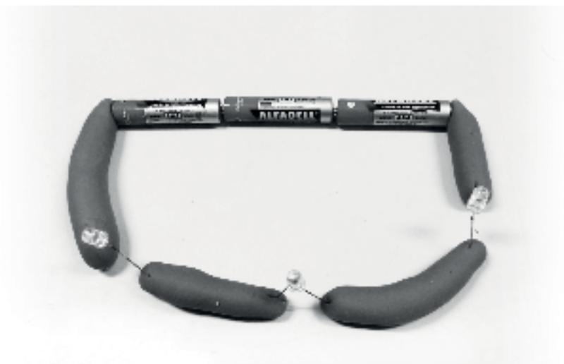
Figura 3: Circuito em série usando massa de modelar.
