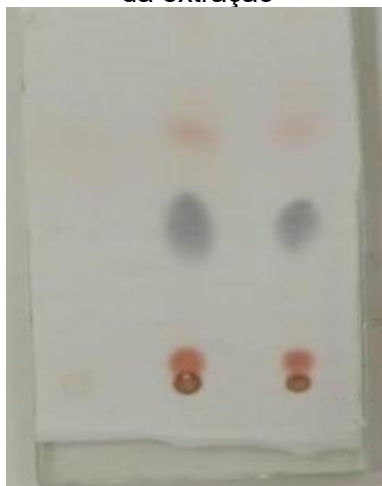
Figura 21. Placa cromatográfica em camada delgada na qual foi aplicado o produto obtido da extração
