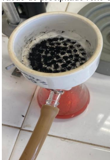
Figura 18. Filtração à vácuo do precipitado roxo escuro obtido na reação
