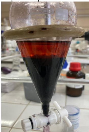
Figura 19. Separação líquido-líquido onde na parte inferior está a fase orgânica com diclorometano e meu produto e na parte superior está a fase aquosa com os sais formados
