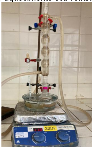
Figura 16. Sistema de aquecimento sob refluxo e agitação magnética
