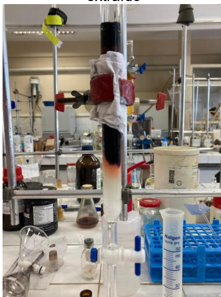
Figura 22. Cromatografia em coluna de sílica gel para purificação do produto anteriormente extraído
