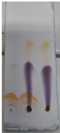
Figura 12. Placa cromatográfica em camada delgada na qual o 1º spot foi aplicado o material de partida, o 2º spot o misto e no 3º spot o produto da reação
