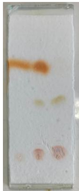
Figura 6. Placa cromatográfica em camada delgada na qual o 1º spot foi aplicado o material de partida, o 2º spot o misto e no 3º spot o produto da reação
