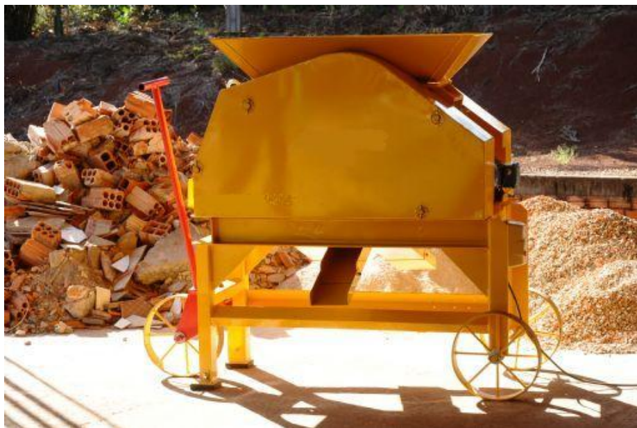
Figura 7 - Máquina de reciclar resíduos da construção civil.
