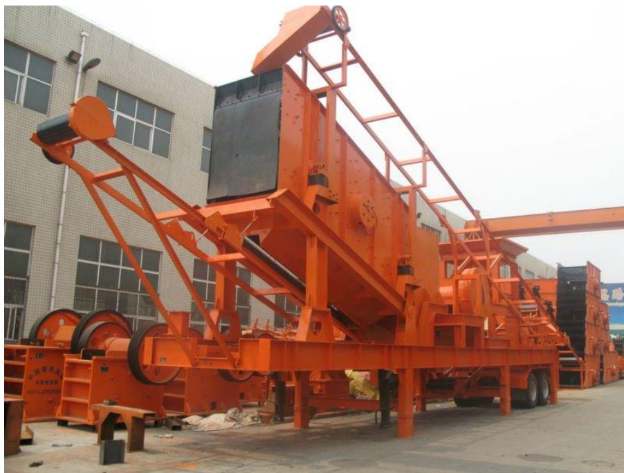
Figura 8 - Estação móvel de britagem de resíduos da construção civil.
