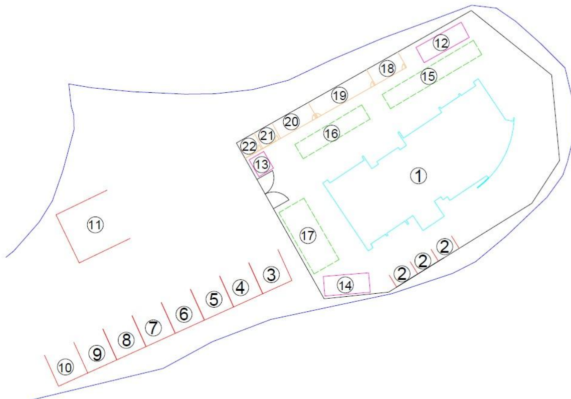
Figura 13 - Arranjo físico do canteiro de obra.
