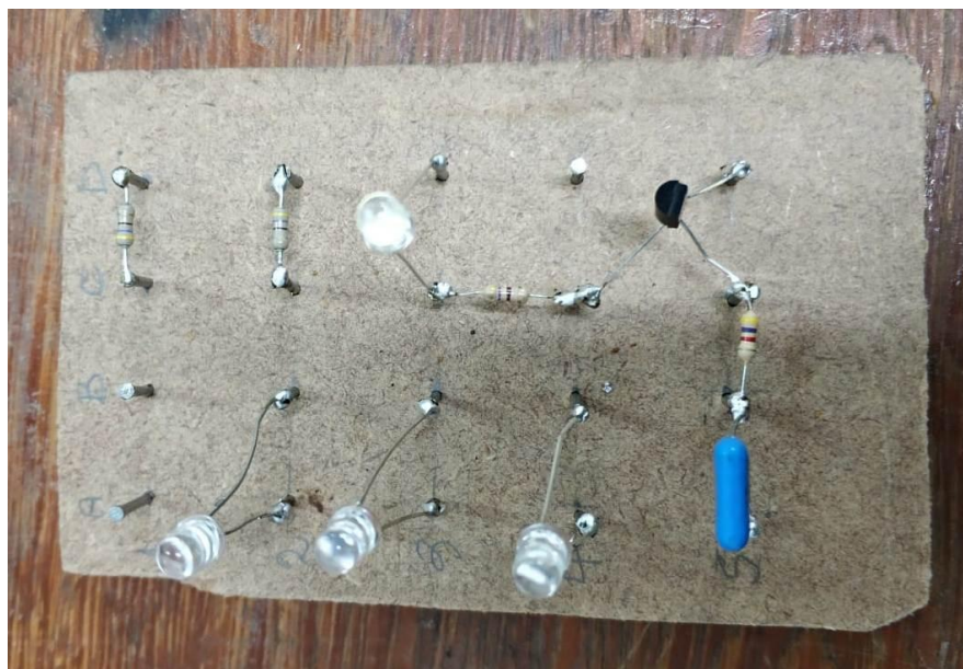
Figura 6: Resultado da Soldagem de Componentes na Base de Montagem
