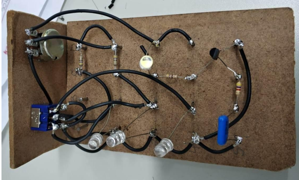
Figura 11: Soldagem dos Condutores Necessários (Parte III)
