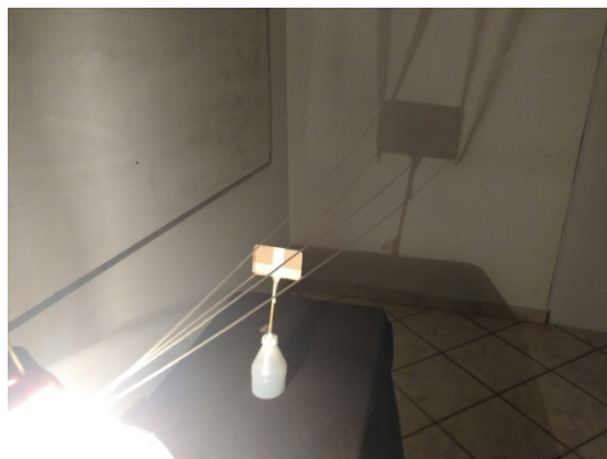
Figura 8 - Montagem do aparato experimental, com barbante simulando a propagação retilínea dos raios luminosos.
