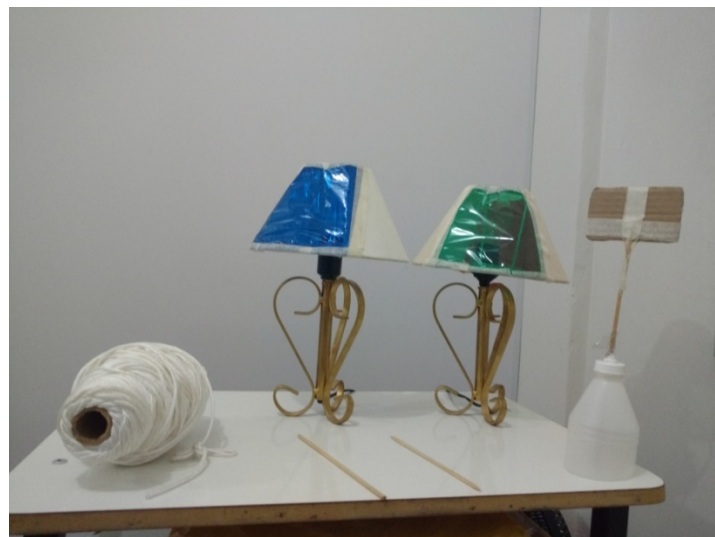
Figura 6 - Aparato experimental: dois abajures, cartão com suporte, barbante e palitos de churrasco.
