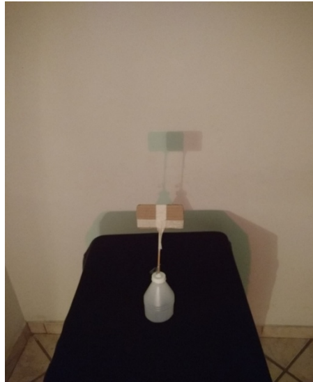
Figura 9 - Formação de sombra e penumbra a partir dos dois abajures, simulando uma fonte de luz extensa.
