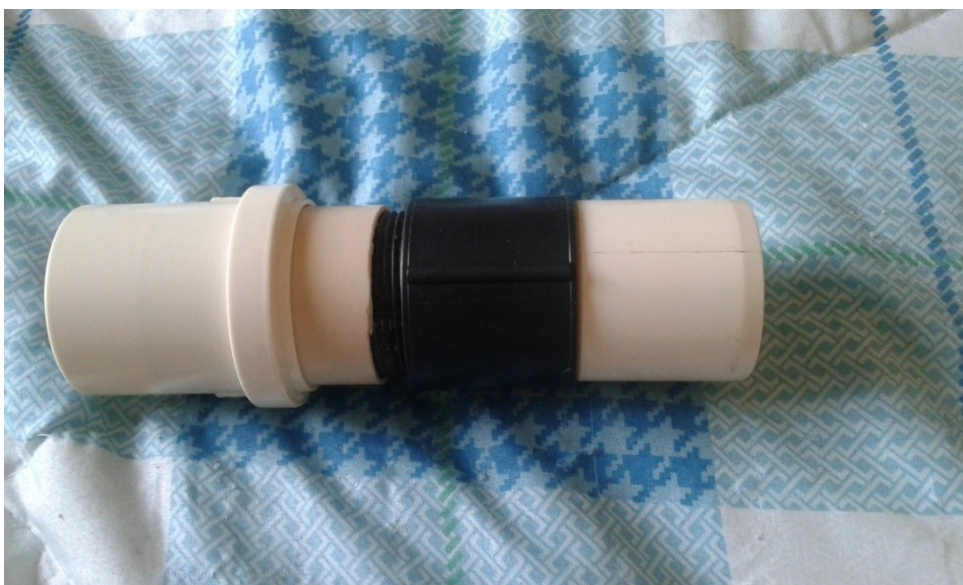
Figura 6.3. redutor acoplado no nípel Fonte: foto da autora
