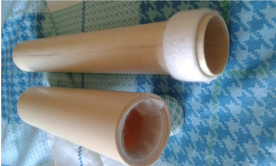
Figura 5.1 Extremidades dos tubos com o feltro adevido Fonte: Foto da autora
