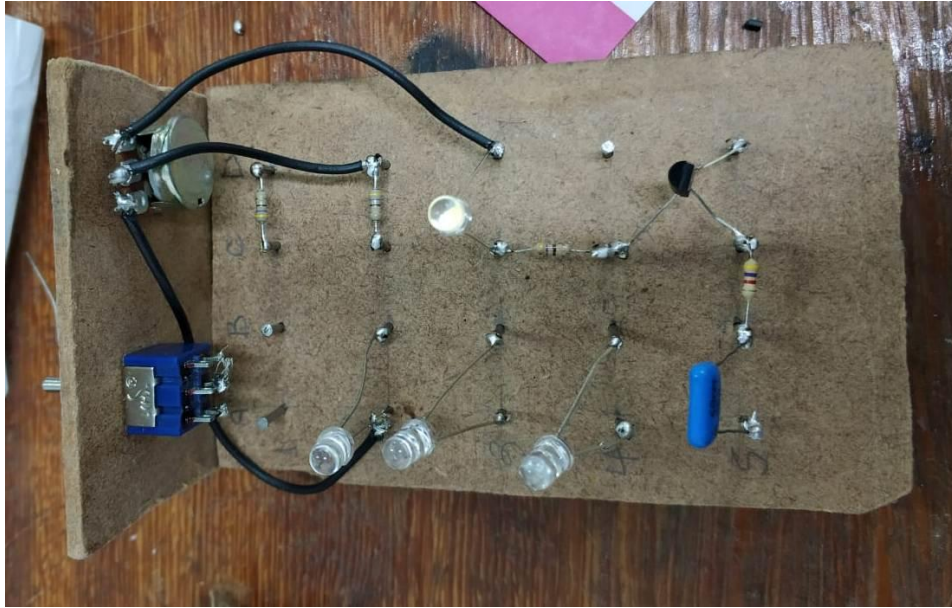
Figura A.9: Soldagem dos Condutores Necessários (Parte I)
