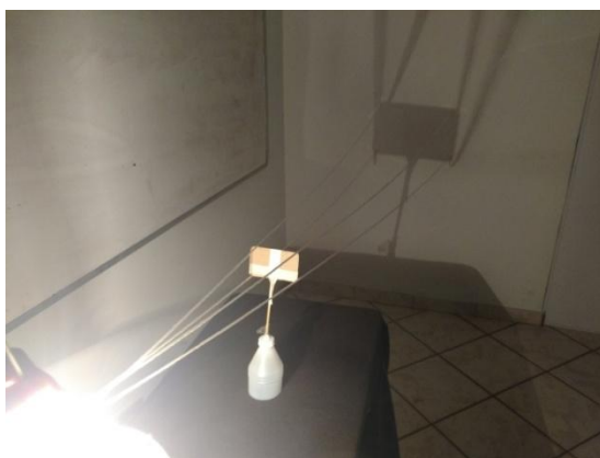
Figura 8 - Montagem do aparato experimental, com barbante simulando a propagação retilínea dos raios luminosos.
