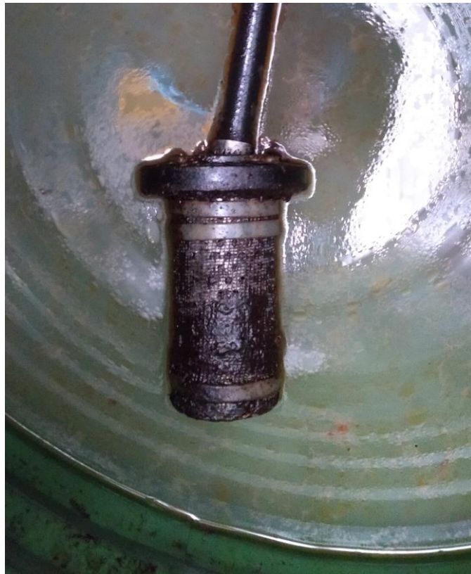
Figura 17: Filtro do sistema de recuperação da Ficep 1003 Fonte: Autor
