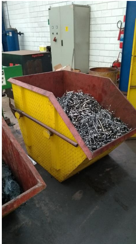
Figura 8: Caçamba de armazenamento de cavacos Fonte: Autor
