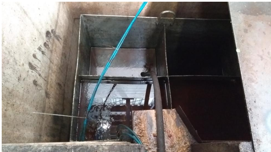
Figura 16: Reservatório de fluidos da Ficep 1003 Fonte: Autor
