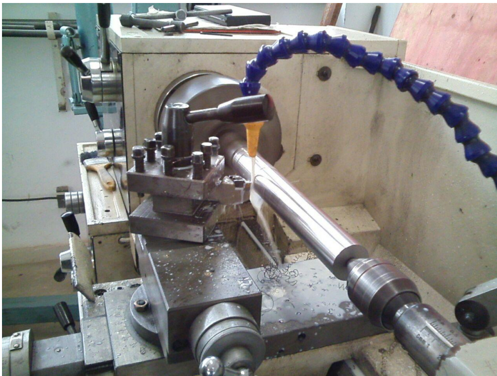
Figura 10. Sistema convencional de lubrificação e refrigeração pela técnica de jorro.
