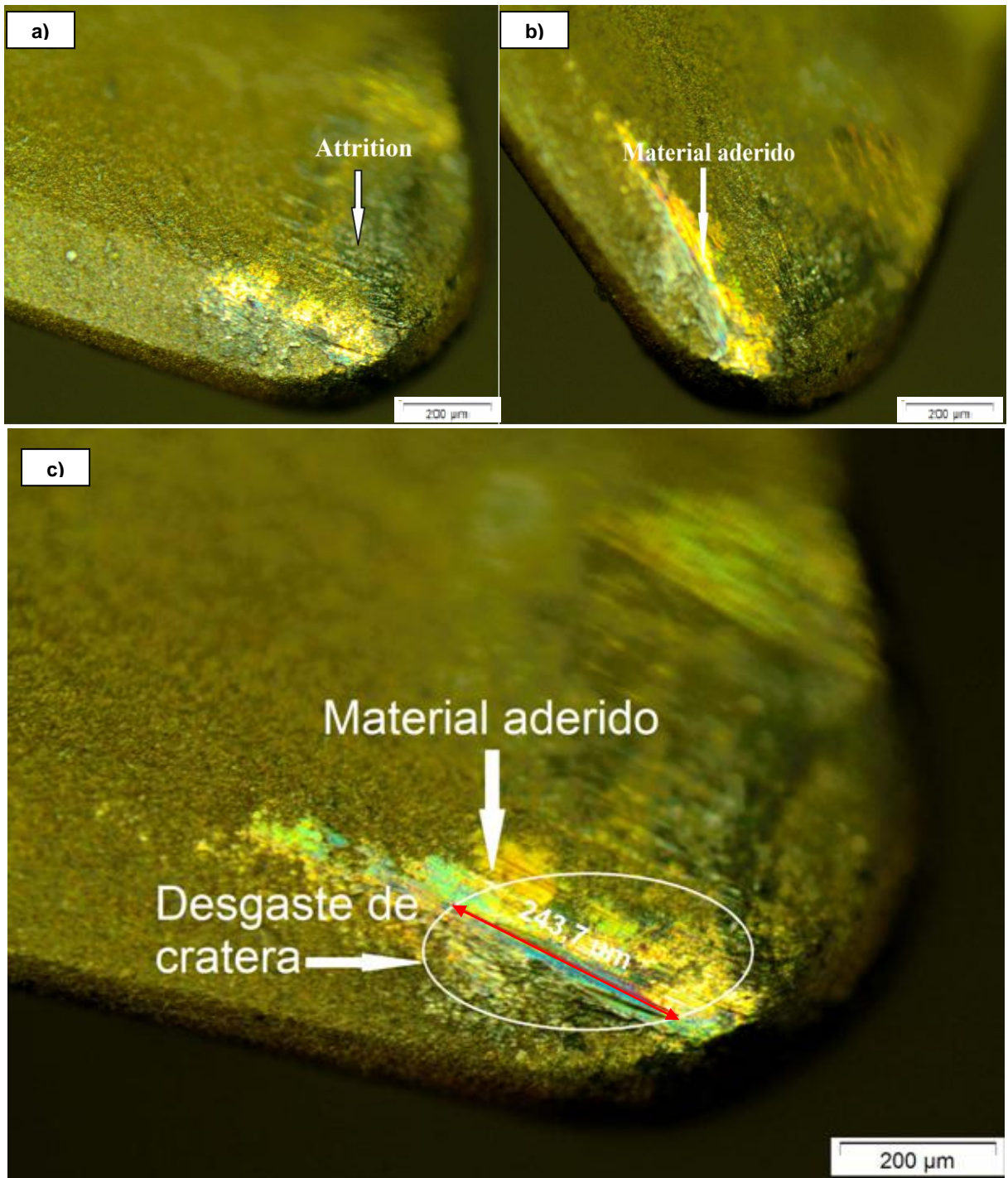
Figura 20. Evolução do desgaste de cratera da ferramenta a cada intervalo de 40 segundos de torneamento, a) após 40 seg b) após 80 seg c) após 120 seg, utilizando Fluido de corte Unix solúvel 100.
