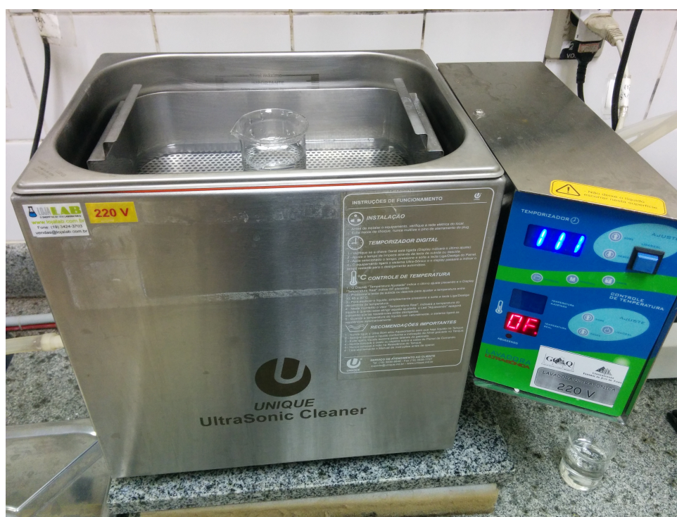
Figura 47 – Lavadora ultrassônica utilizada para limpeza dos corpos de prova antes da pesagem.
