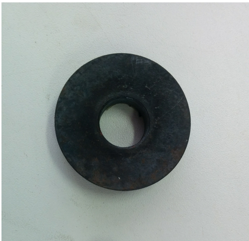
Figura 41 – Amostra de bainita pós-austêmpera com camada escura de revestimento.
