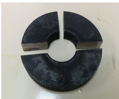
Figura 42 – Esquema de corte da amostra para sua análise microestrutural.
