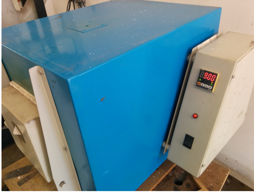
Figura 38 – Corpos de prova sendo aquecidos acima da temperatura de austenitização, à 900°C.
