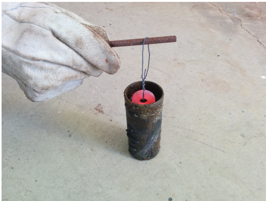
Figura 39 – Amostra de roda sendo resfriada no banho de sais à 380°C.
