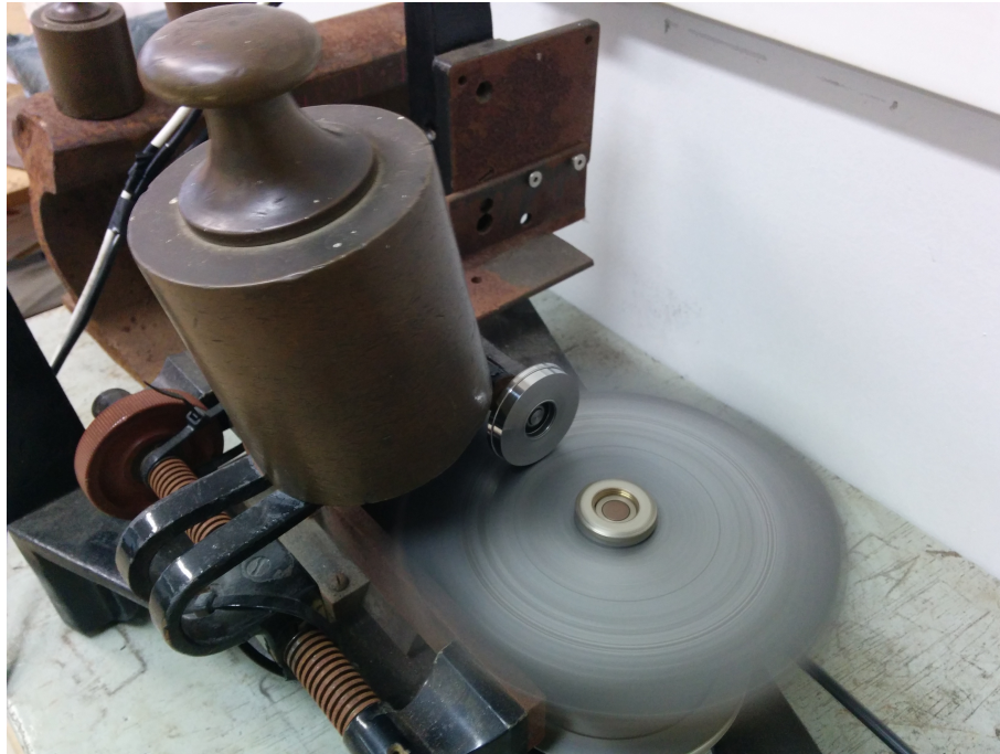
Figura 29 – Tribômetro do tipo rolo contra disco utilizado nos ensaios.
