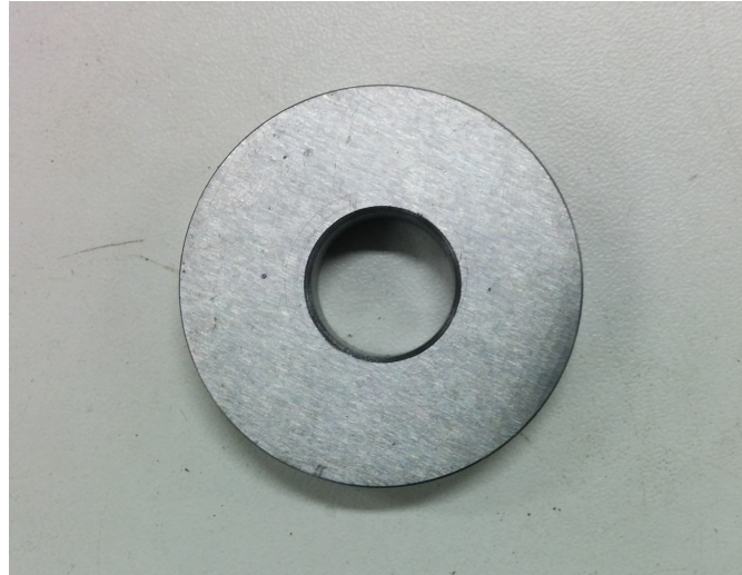
Figura 32 – Roda em miniatura usinada a partir do material retirado da roda real.
