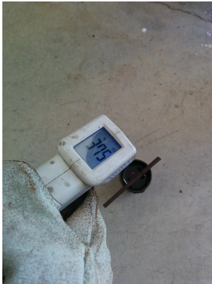
Figura 40 – Monitoramento de temperatura feito através de um pirômetro.
