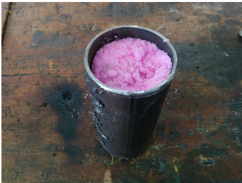
Figura 36 – Recipiente soldado com sal da mistura de nitrato de potássio e nitrito de sódio à temperatura ambiente.
