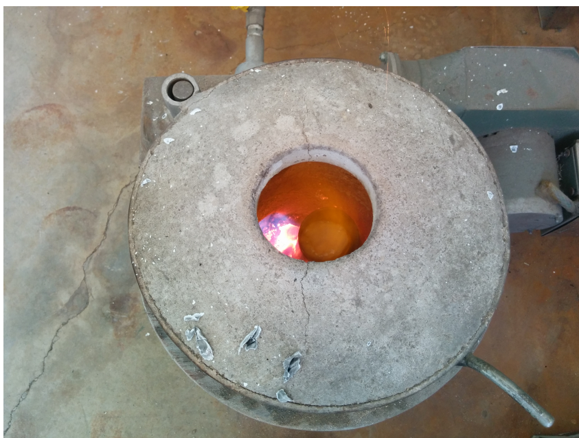
Figura 37 – Mistura de sais sendo aquecida e fundida no forno à gás.
