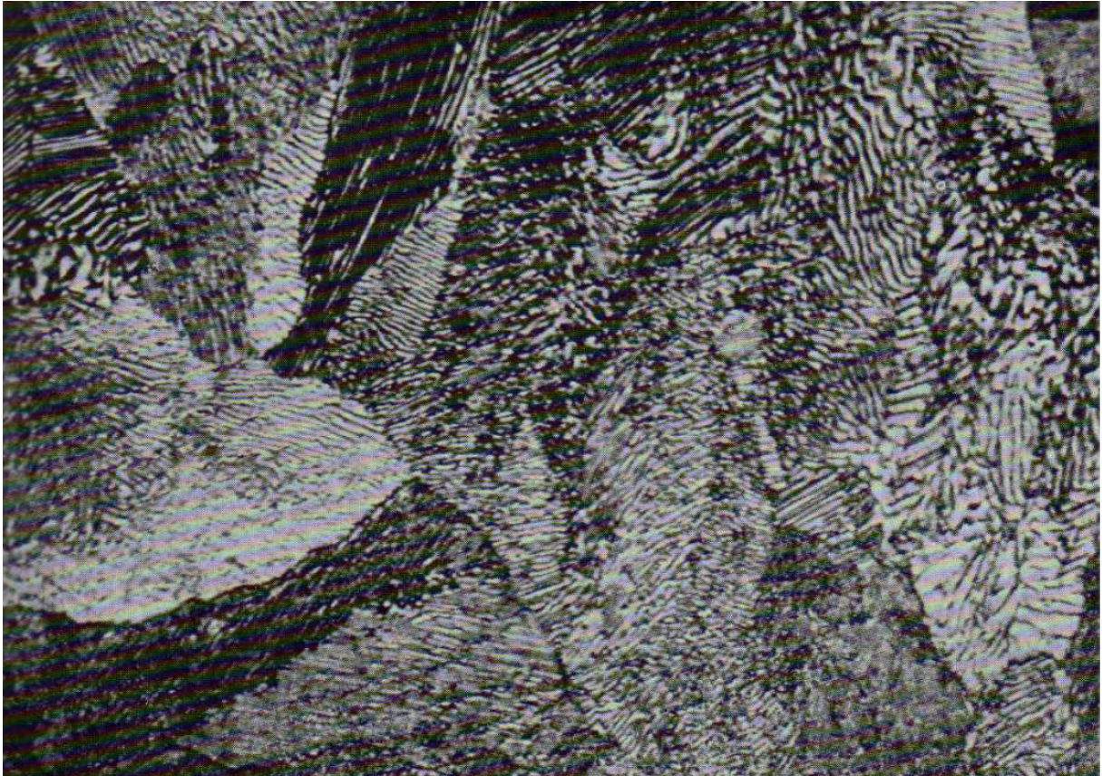
Figura 45 – Aço eutetóide. Grãos de perlita, demonstrando a estrutura lamelar. Ataque: nítrico. [8]
