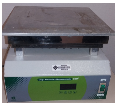
Figura 15 – Chapa aquecedora utilizada no ensaio macrográfico
