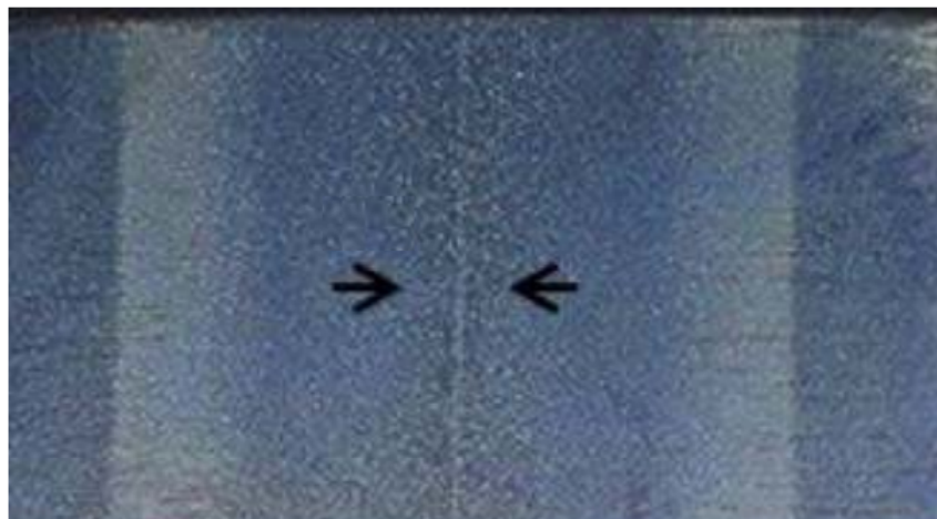
Figura 7 – Macrografia de bolete de solda por centelhamento
