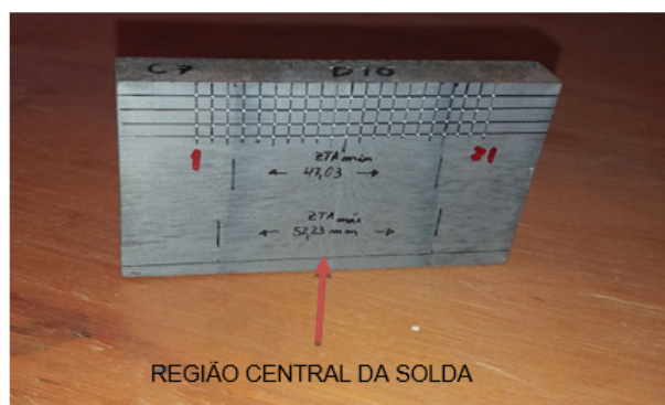
Figura 21 – Disposição dos pontos de dureza
