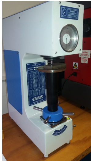
Figura 14 – Durômetro utilizado para ensaios de dureza
