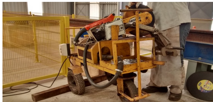
Figura 12 – Equipamento de corte de trilho por abrasão
