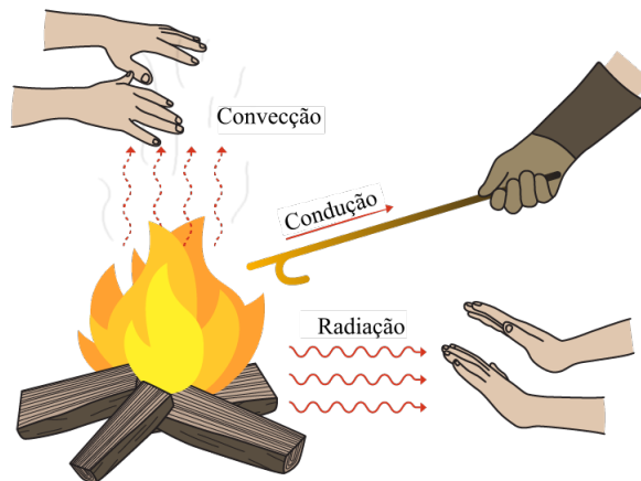
Figura 2.2 – Exemplo prático das 3 formas de transferência de calor.
