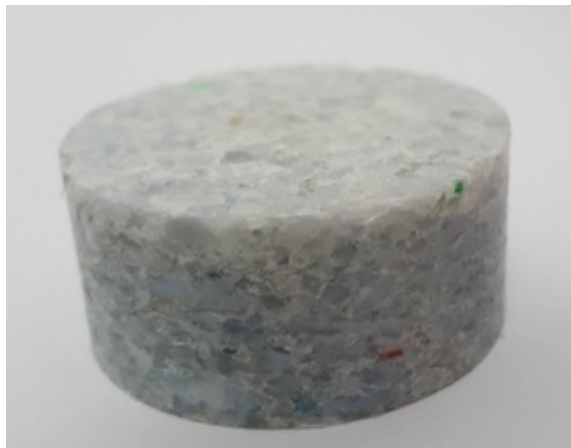
Figura 26 – Resultado da sinterização na temperatura de 155^{\circ}C
