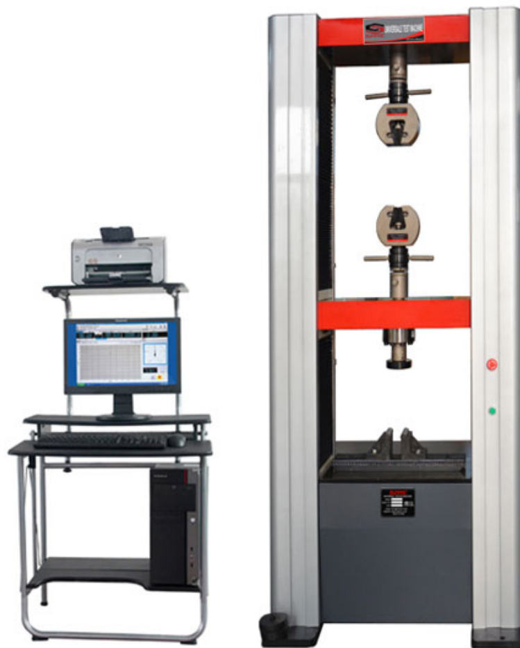
Figura 23 – Equipamento utilizado para realização do ensaio de compressão.
