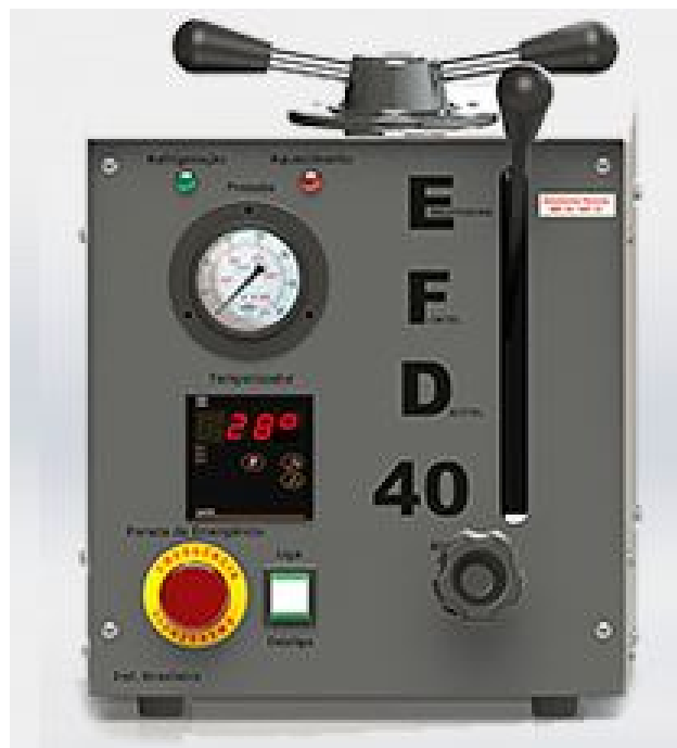
Figura 21 – prensa utilizada para sinterização dos corpos de prova.
