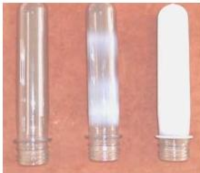
Figura 8 – Pré-forma de PET como um material: a) Amorfo; b) Parcialmente cristalino e c) cristalino.
