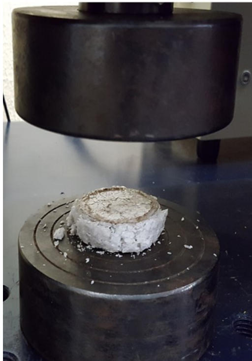
Figura 36 – Corpo de prova após o ensaio de compressão.
