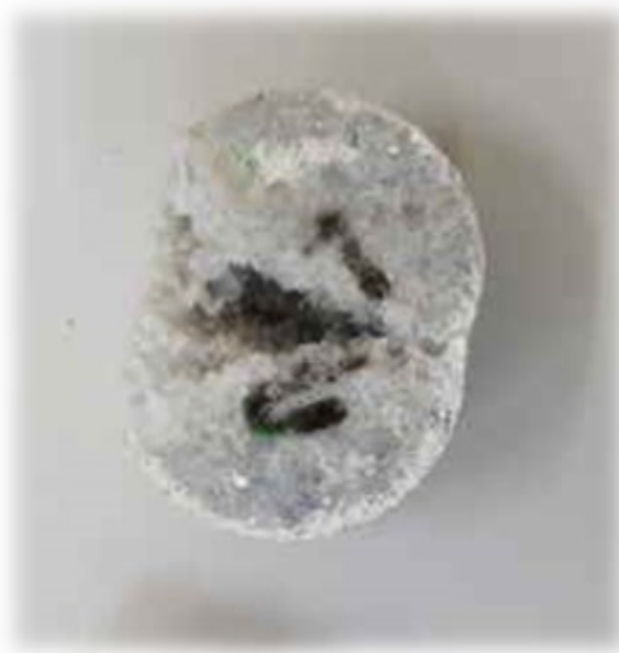
Figura 39 – Corpo de prova após o ensaio de compressão diametral.
