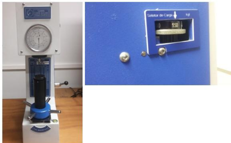
Figura 58: Fotos do durômetro Equilam EQTSM utilizado. (a) Vista geral; (b) Carga selecionada de 150kgf
