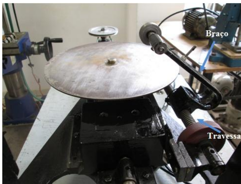
Figura 59: Sistema de fixação dos corpos de prova no tribômetro
