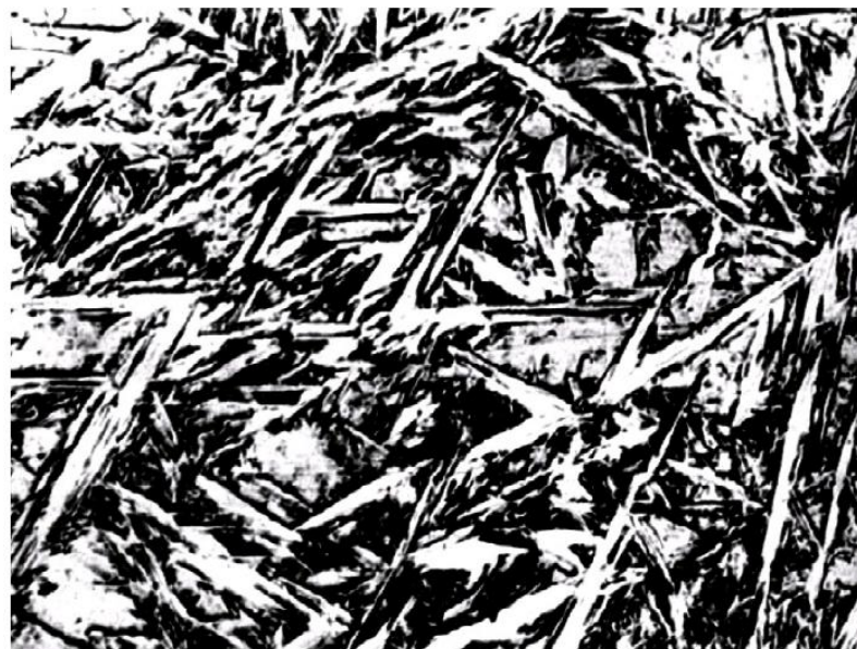
Figura 26: Microestrutura de aço duro temperado em água demonstrando as agulhas escuras de martensita em um fundo de austenita retida, que não se transformou durante o resfriamento brusco, em branco
