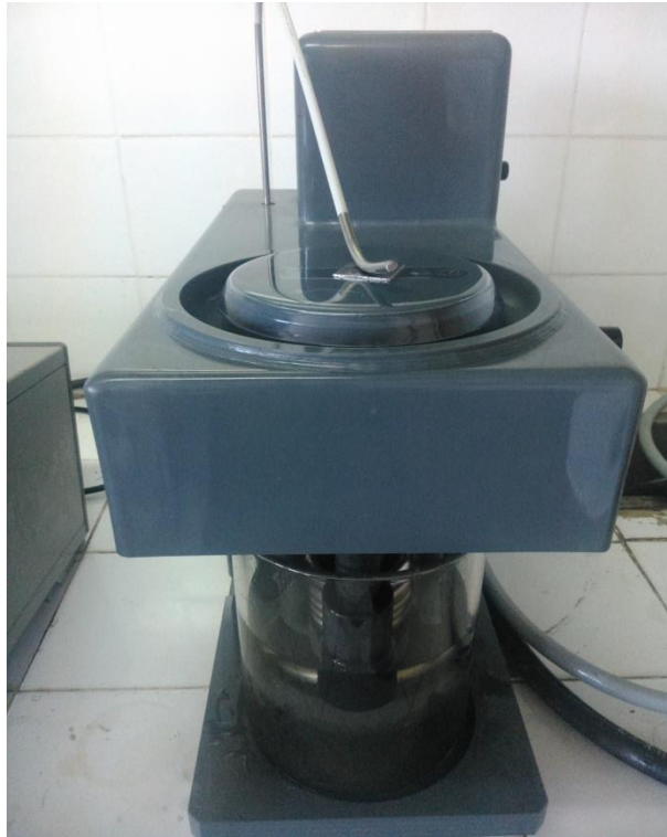
Figura 26 – Equipamento para polimento eletrolítico Polisecc C25
