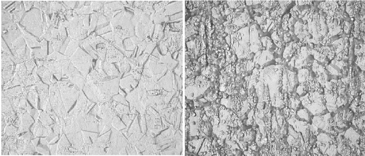
Figura 8 – Fotomicrografias do aço AISI 304L como recebido e sensibilizado, respectivamente, em forno a 675°C por 20h (500X)
