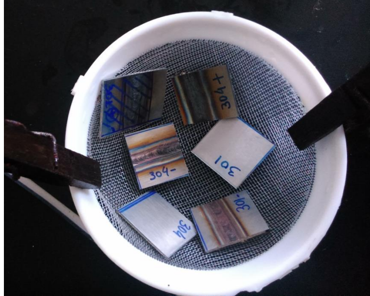
Figura 24 – Disposição das amostras para ensaio de corrosão
