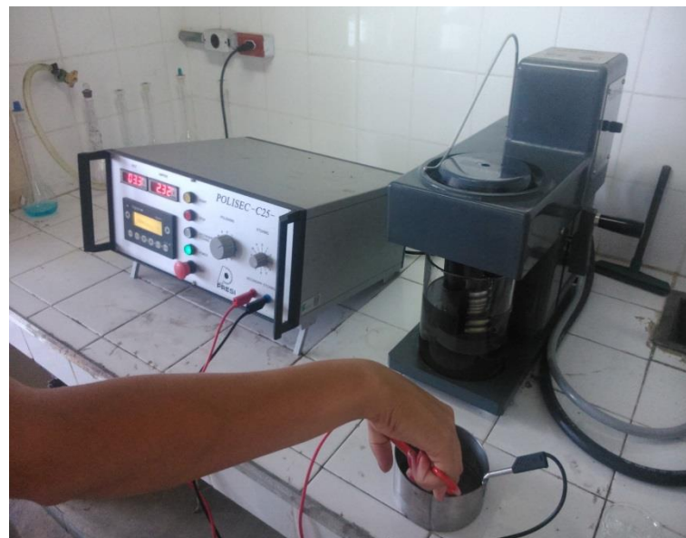
Figura 28 – Ataque secundário com ácido oxálico
