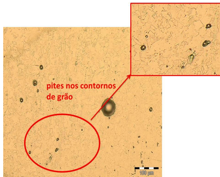
Figura 38 – Fotomicrografia do aço AISI 301 após ataque eletrolítico (200X)
