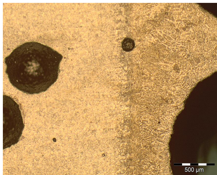
Figura 49 – Fotomicrografia dos pites no metal base, na ZAC e no metal de solda do aço AISI 301 soldado com baixo nível de energia (50X)
