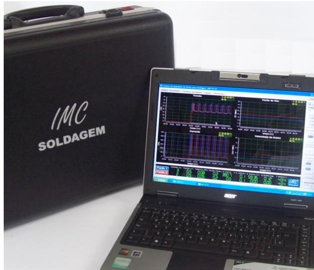
Figura 7 - Sistema de Aquisição de dados SAP V4 Fabricante: IMC/LABSOLDA - UFSC
