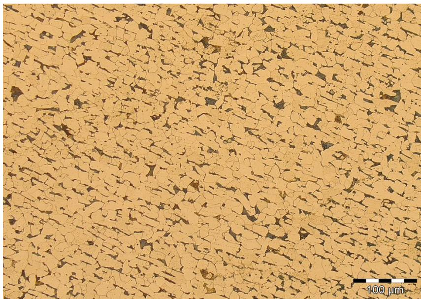
Figura 17: Aspecto Micrográfico do Metal de Base, Seção Transversal, Nital 3%, 200x.
