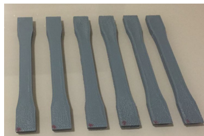
Figura 28 – Corpos de prova padronizados impressos 3D em plástico ABS.
