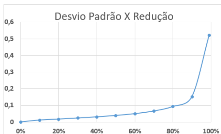
Figura 35 – Gráfico que mostra a relação entre o desvio padrão das medidas de distância entre as malhas e a porcentagem de redução das malhas quando comparadas com a malha original.
