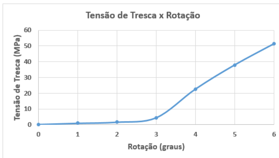
Figura 39 – Comportamento da tensão de Tresca na guia cirúrgica em função da rotação imposta no formão de corte.
