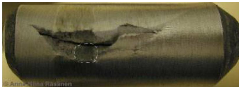
Figura 20 – Flat spot localizado em fratura, corpo de prova sujeito ao teste de flexão. (Fonte: RASANEN, A. N. 2011)
