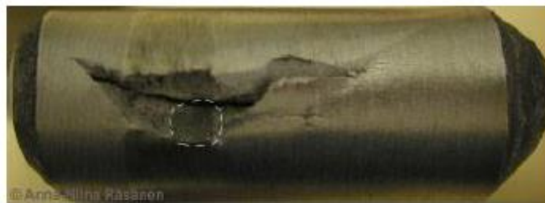
Figura 15: Superfície de fratura devido a um flat spot . Fonte: RÄSÄNEN, MARTIKAINEN, 2011.
