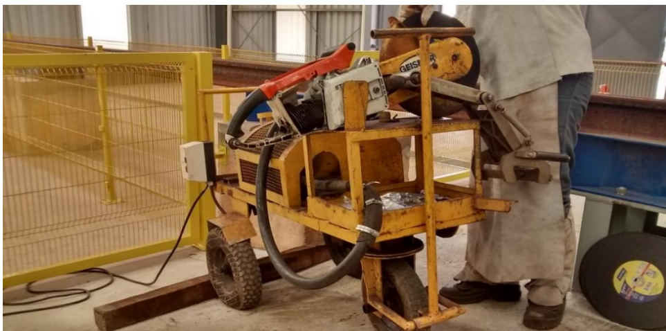
Figura 52: Equipamento de corte de trilho por abrasão. Fonte: Próprio autor.
