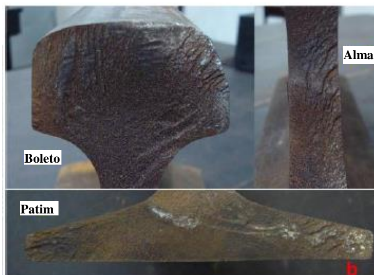
Figura 24: Regiões com fratura frágil (marcas de sargento), na alma, boleto e patim do trilho. Fonte: Adaptado de GODEFROID ET AL, 2014.
