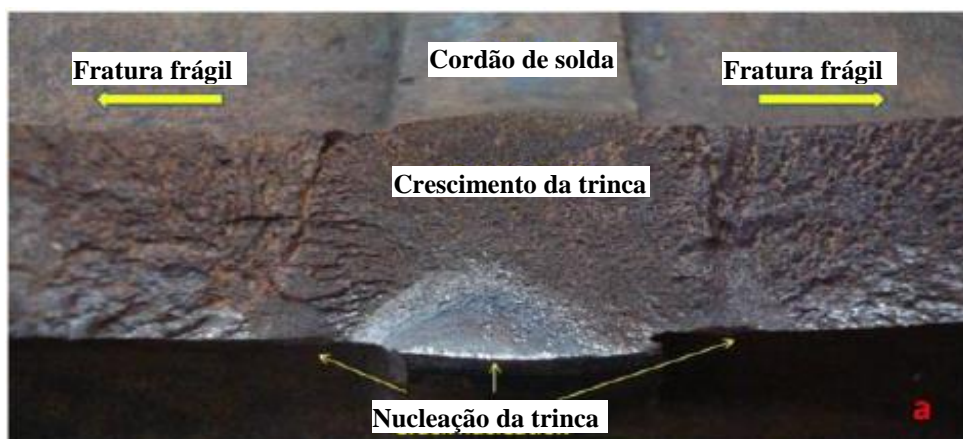
Figura 22: Regiões de nucleação e crescimento de trinca. Fonte: Adaptado de GODEFROID ET AL, 2014.
