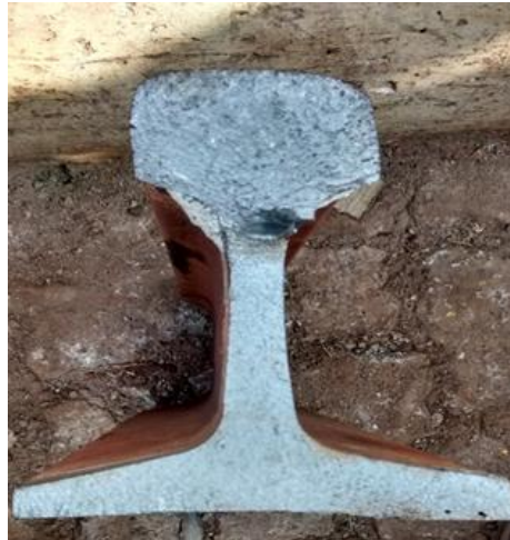
Figura 28: Trinca a quente com início no raio entre o boleto e a alma. Fonte: Curso de soldagem de trilhos, Professor Dr. Luiz Alves (2016)
