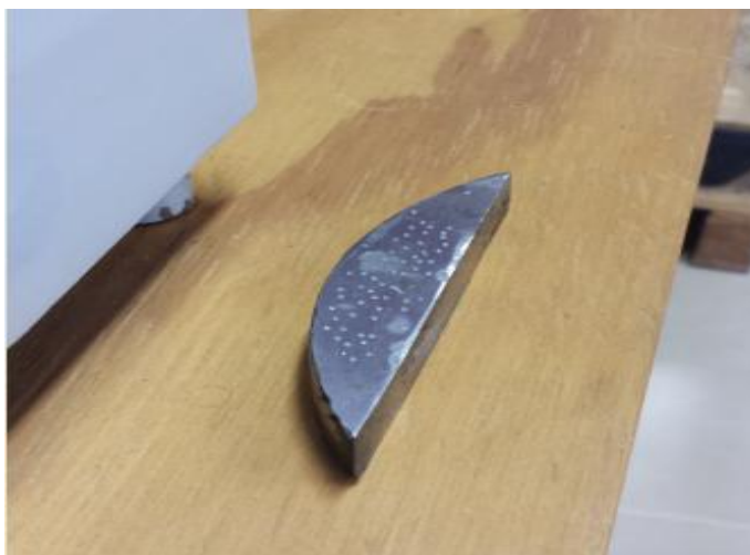
Figura 38: Corpo de prova com dureza padrão para calibragem do Durômetro Rockwell. Fonte: o autor
