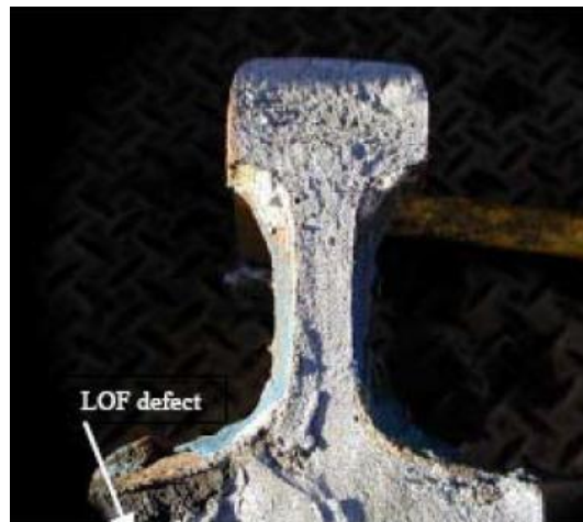
Figura 25: Solda com falta de fusão no patim do trilho. Fonte: (WTIA, 2006)
