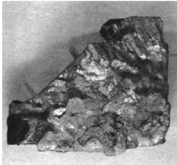
Figura 29: Superfície de fratura exibindo uma aparência de defeito rock candy . Fonte: (VALVES, 2003)
