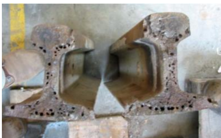
Figura 27: Solda com forte porosidade. Fonte: (WTIA, 2006)
