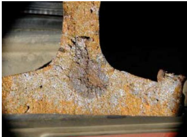
Figura 24: Rechupe na região entre a alma e o patim. Fonte: (WTIA, 2006)
