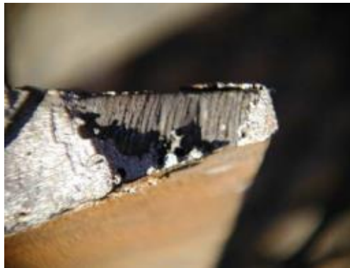
Figura 25: Exemplo de lack of fusion na região do patim. Fonte: WTIA, 2015.
