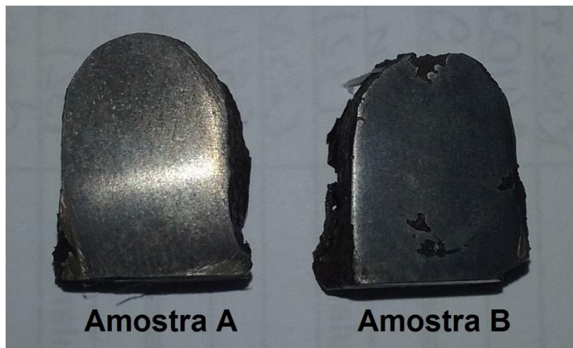
Figura 27: Amostras de rebarba da área do jito. Fonte: a autora.
