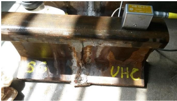
Figura 28: Equipamento de ultrassom manual. Fonte: Equipe do Projeto.
