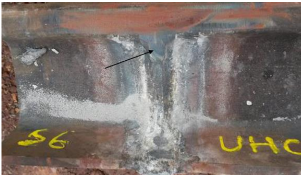
Figura 32: Evidência de defeito visual na amostra S06. Fonte: Relatório interno da VALE S.A. – EFC, número 19361 (SOUZA E BALDEZ, 2016).
