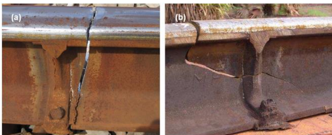
Figura 21: (a) Fratura straight break em solda aluminotérmica, iniciada no patim; e (b) fratura horizontal split web iniciada na região da alma do trilho.
