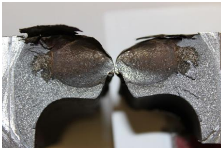
Figura 24: Fratura em trilha com rechupe.
