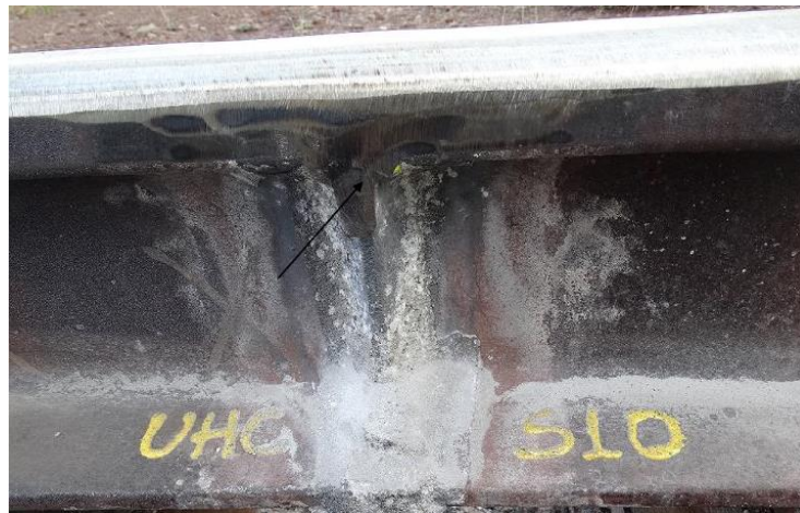
Figura 37: Evidência de defeito visual na amostra S10.
