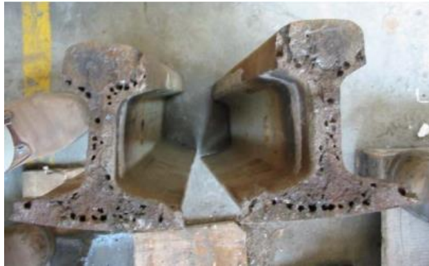
Figura 22: Solda com forte porosidade. Fonte: WTIA, 2015.
