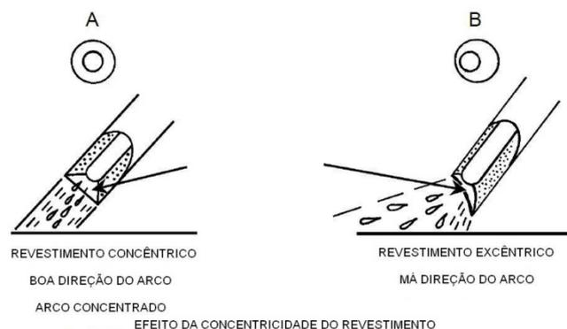
Figura 2 - Efeito da concentricidade do revestimento.
