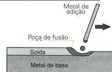
Figura 1 Metal de base, de adição e poça de fusão
