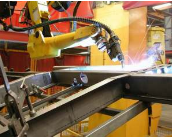
Soldagem robotizada com arames tubulares: altíssimos níveis de qualidade e produtividade.
