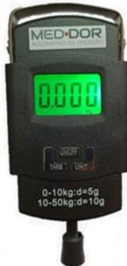
Figura 2 - Algômetro de pressão portátil adaptado de uma balança suspensa
