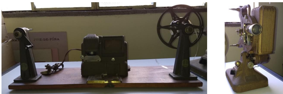
Figura 24: Nas imagens, vemos, respectivamente, a máquina para visualizar, cortar e colar frames , e o projetor 16 mm utilizados por Nahim Miana. Ambos os equipamentos também foram doados à Divisão de Memória da Funalfa. Foto: Nilo Araújo Campos.
