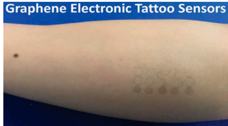
Figura 12. Tatuagem a partir de sensores eletrônicos de grafeno. Fonte: (AMERI e al, 2017).
