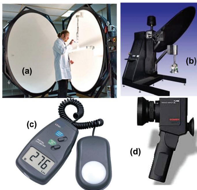
Figura 18 – Equipamentos empregados no estudo de iluminação: (a) esfera integradora, (b) goniofotômetro, (c) luxímetro e (d) luminancímetro.
