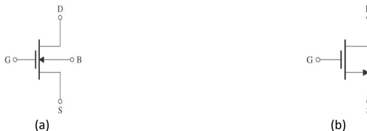
Fig. 1 – Símbolos do MOSFET (canal n): (a) completo (4 terminais); (b) simplificado (3 terminais).
