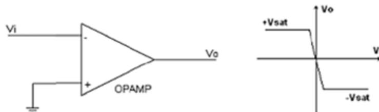
Fig. 1 – Comparador inversor e sua característica de transferência.
