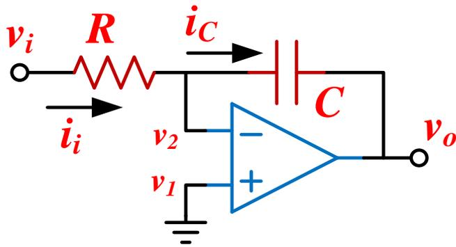
Neste circuito:  $v_2 = v_1 = 0$
