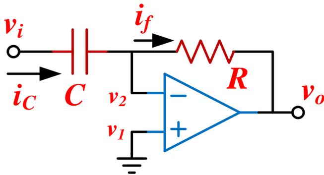
Neste circuito:  $v_2 = v_1 = 0$
