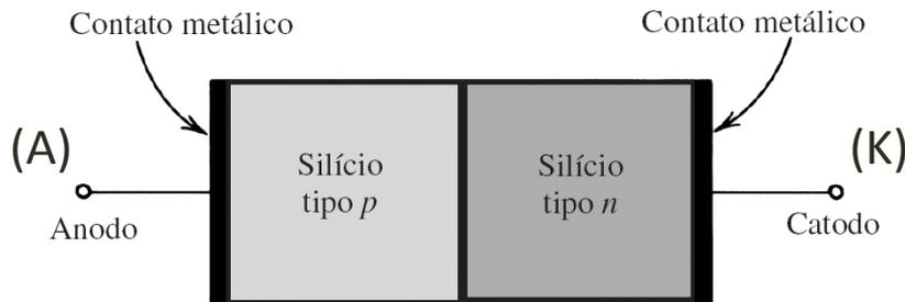
**Figura 3.39** Estrutura física simplificada do diodo de junção. (A geometria real é dada no Apêndice A.)
