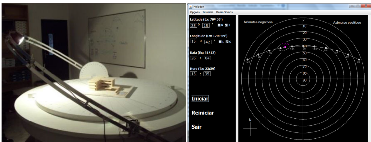
Figura 15 – (a) Visão do Heliodon desenvolvido (b) Ambiente operacional desenvolvido
