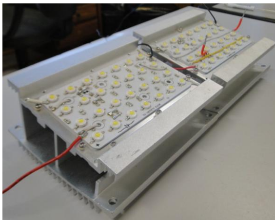
Figura 72 – Módulos de LEDs utilizados como carga para o driver proposto.
