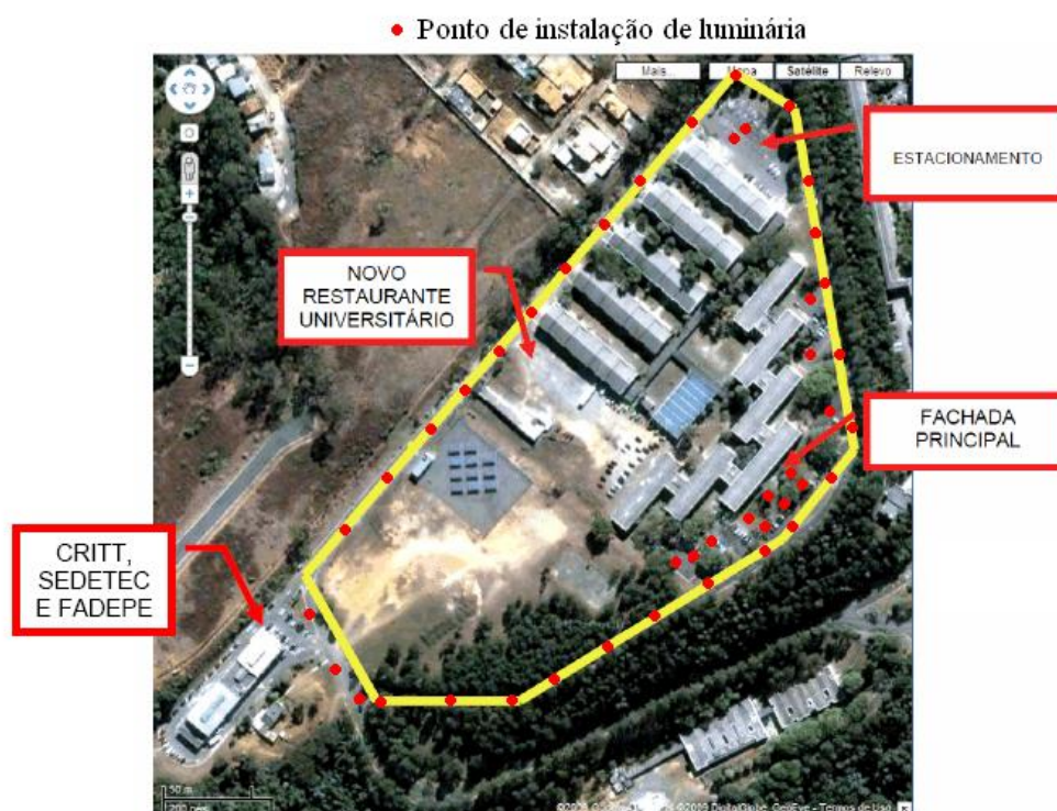
Figura 108— Anel viário da faculdade de engenharia da UFJF com marcação dos pontos de instalação das luminárias.
