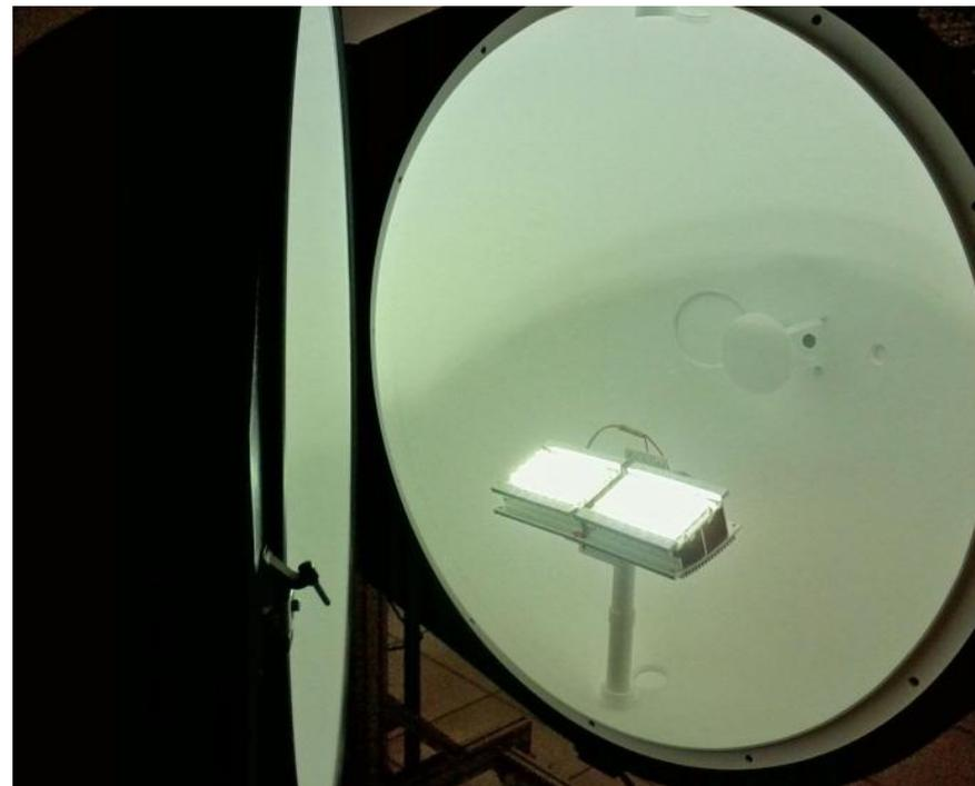
Medição de módulos de LEDs
