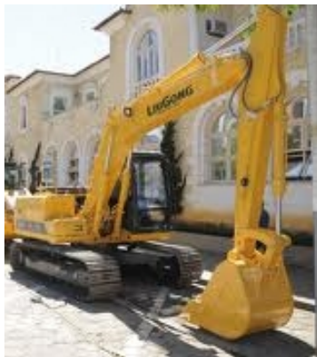
Figure : Rótulas (braço da retroescavadeira).
