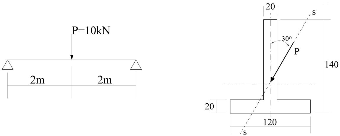
**Respostas:**  $\theta = -59,89^\circ$  (horário a partir de  $z$ );  $\sigma_{\max}^T = 145,44 \text{ MPa}$ ;  $\sigma_{\max}^C = -109,96 \text{ MPa}$ .
