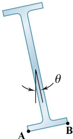
Considere  $\frac{h_{\text{seção}}}{b_{\text{seção}}} = 4$  e  $\frac{I_{\bar{z}}}{I_{\bar{y}}} = 10$ , onde  $\bar{z}$  e  $\bar{y}$  representam os eixos baricêtricos, e admita que os pontos A e B estejam sujeitos à tração.
