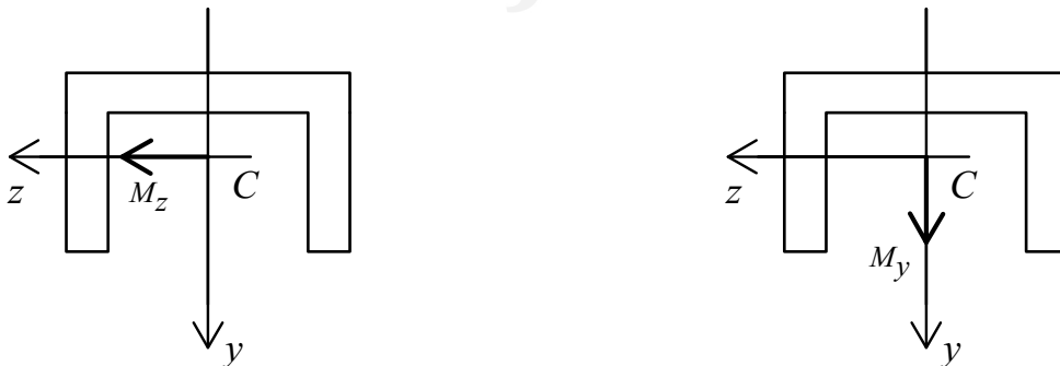
Figura 1.5: a) Viga U com ss - vertical; b) Viga U com ss - horizontal
