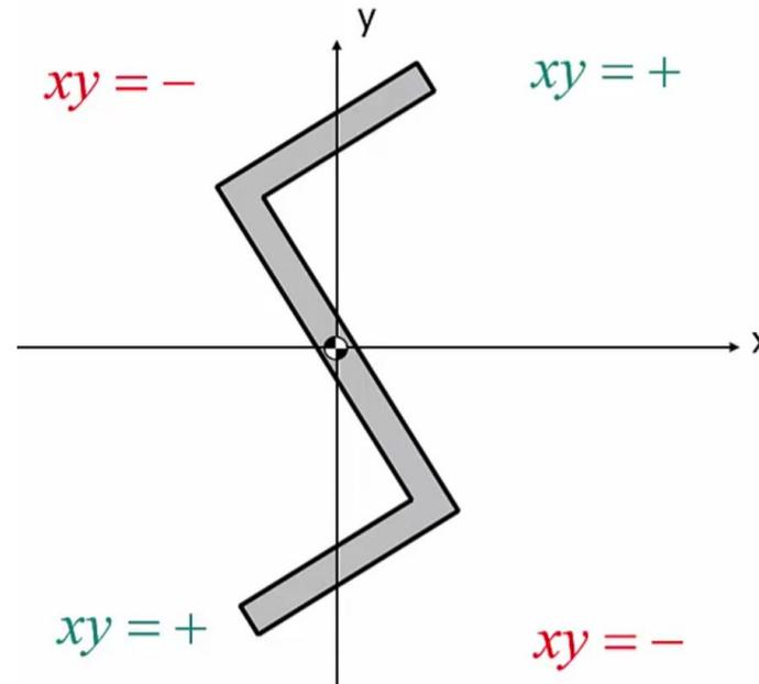
Na figura acima, os eixos  $x$  e  $y$  são eixos principais de inércia, mas **NÃO** são eixos de simetria.
